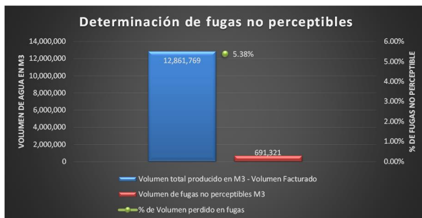
Imagen 28 Fugas no perceptibles en red y tomas
